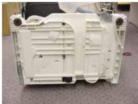
Вытащите пружины двери из корпуса и отсоедините шнуры
