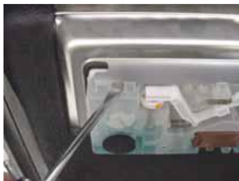
Отогните фиксирующие защелки
