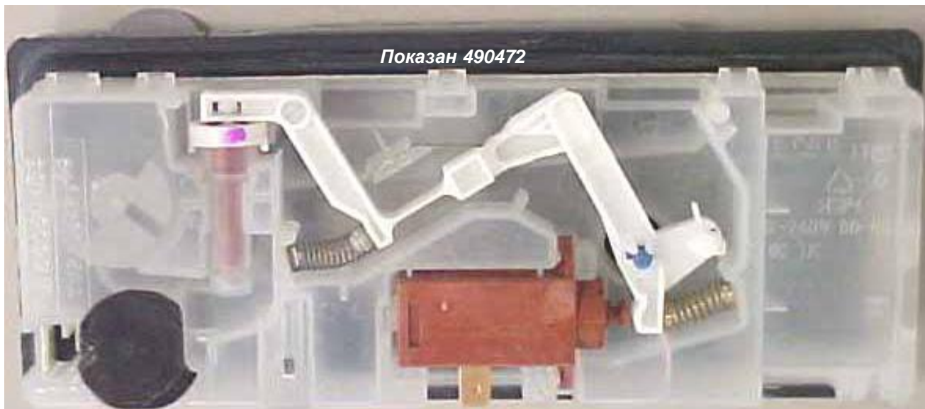
Оптический датчик Геркон Магнитный поплавок Привод дозатора
