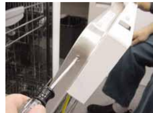
Выкрутить винты панели
