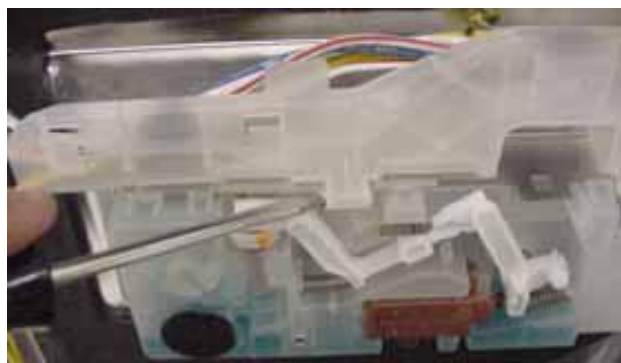
Отсоединить жгут с проводами
