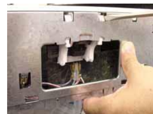
Согните металлические лепестки консоли
