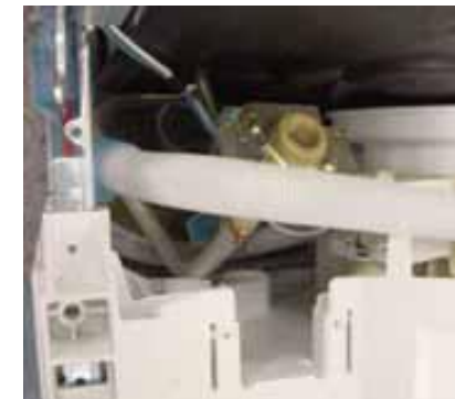
Отсоедините шланг от клапана залива
