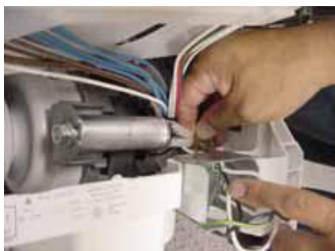
Отключите провод заземления
