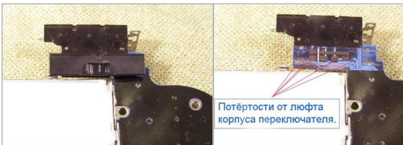
Было бы надежнее, если бы разработчики вместо движкового переключателя поставили бы простые кнопки, как во всех остальных случаях. Ведь переключатель не прерывает питание на всю электронику аппарата, а всего лишь подает слаботочный сигнал управления. Причем нет надобности присутствия этого сигнала постоянно, достаточно кратковременного замыкания соответствующих контактов и фотоаппарат переходит или в необходимый рабочий режим или
